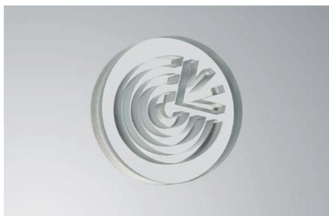
在熔融石英玻璃中制造的结构。
