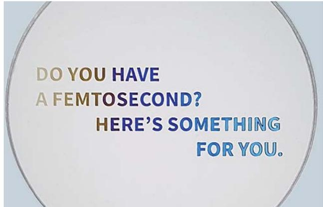
形状诱导双折射延迟的变化导致在平行偏振光中显示不同的颜色。
