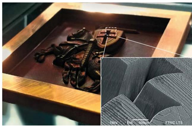
铜三维铣削样品。放大的扫描电镜图像。
